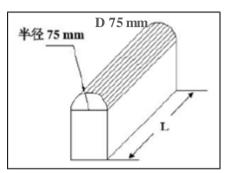
Diagram of the Extrusion device 挤压装置示意图
